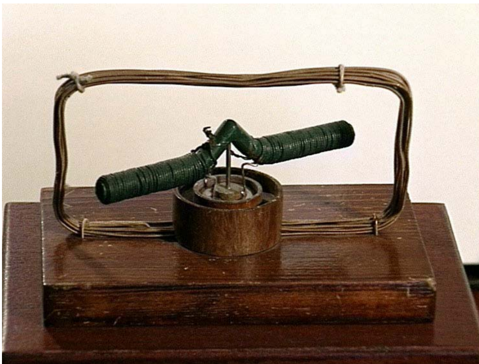
Obr. č. 9 : Elektromagnetický rotor Š.A. Jedlika (1829) 13 (jeden z najstarších zachovaných modelov)
