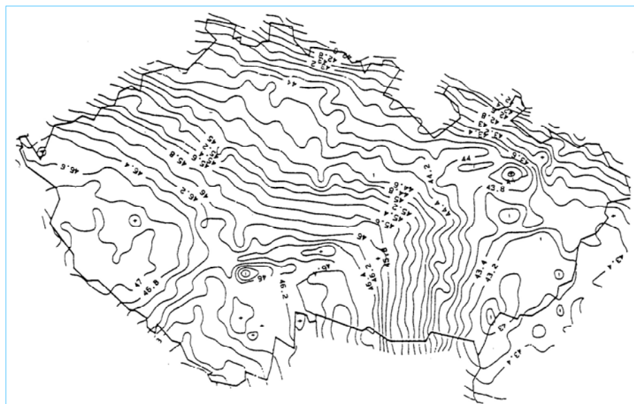
Obr. 12 Detailní průběh gravimetrického geoidu pro území České republiky; rozdíl cca 6 m
